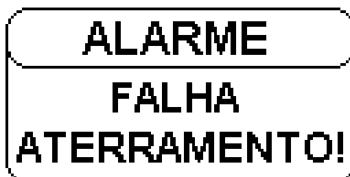
Figura 11 - Tela de Indicação de Falha no circuito de aterramento.
